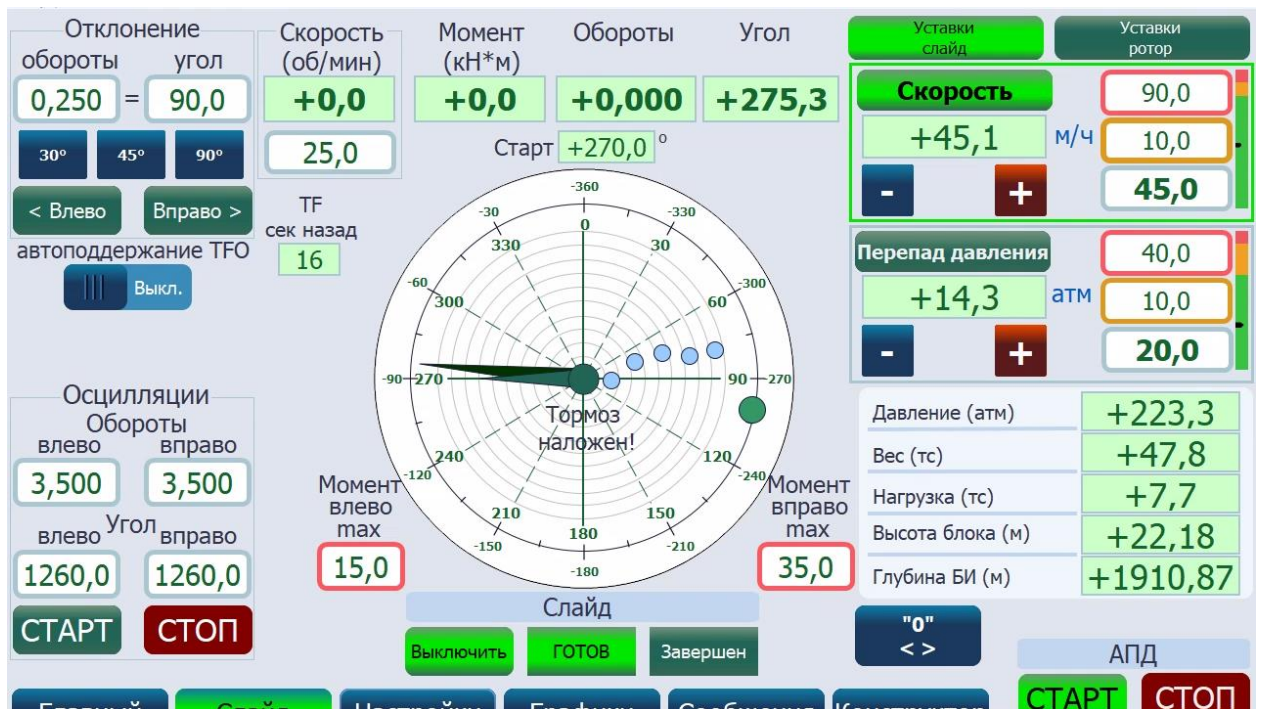
Рисунок 52 – Окно слайд с историей положения отклонителя (отображение бурения РУСом выключено)
