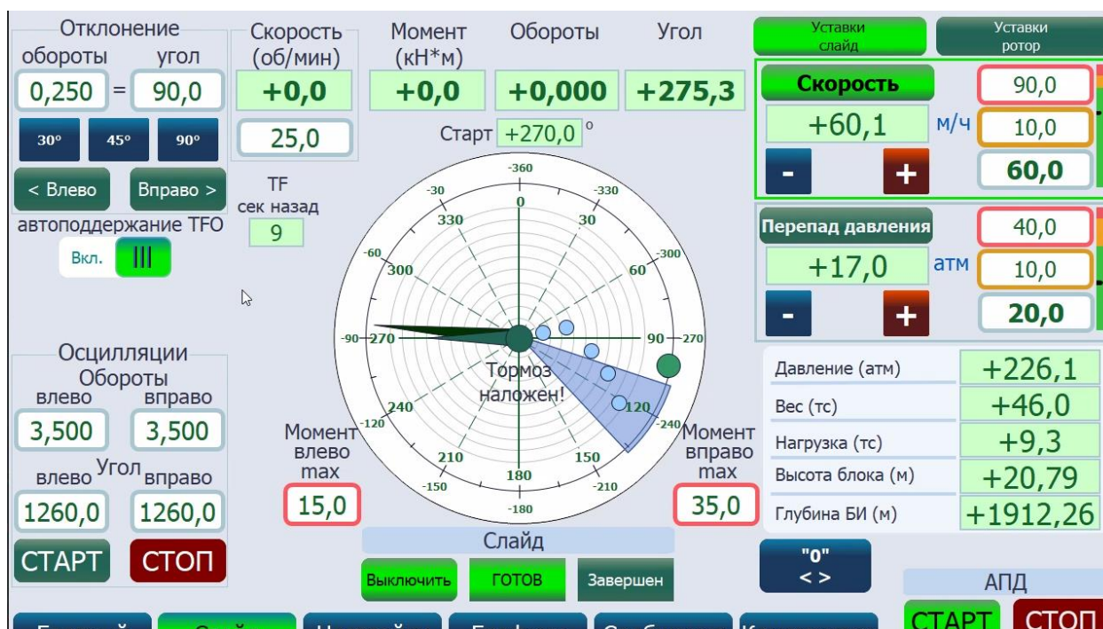
Рисунок 53 – Режим ННБ TOOLFACE с включенной функцией «Автоподдержание TFO» и показанным сектором для удержания
